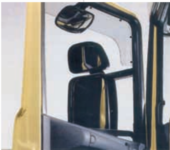
► Fig. 1: Gezichtsveld van een breedtespiegel van klasse IV (Richtlijn 2003/97/EG en KB 25-09-2002)
