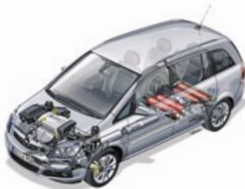
Het gas wordt opgeslagen in cilindervormige gasflessen die in de vloerplaat van de auto geïntegreerd worden.
